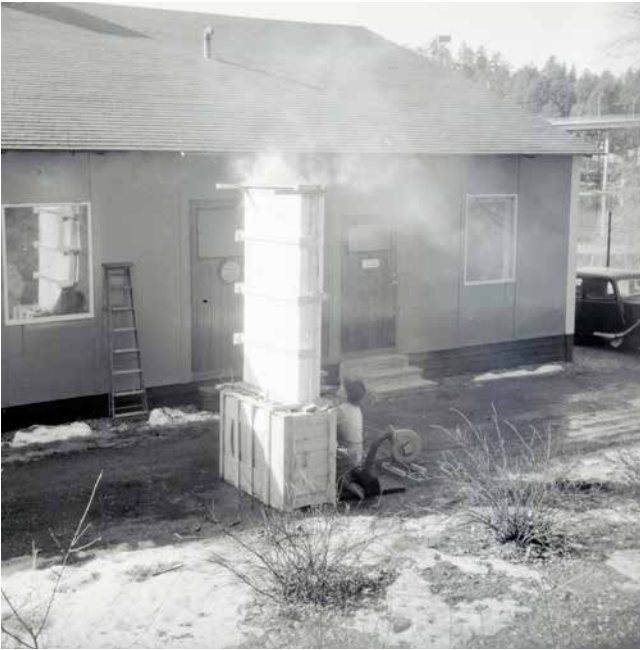
Ovan. Brandprov på tvärvellit utanför laboratoriet i Stocksund. Ur Munters AB:s arkiv hos Centrum för Näringslivshistoria.
